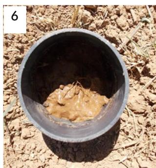
Diferentes fases del ensayo de velocidad de infiltración de agua: 1 y 2) Material, 3) Clavar el cilindro 2 cm en el suelo, 4) Cilindro colocado, 5) Agua aplicada en el cilindro, 6) Suelo tras haber infiltrado el agua aplicada.
